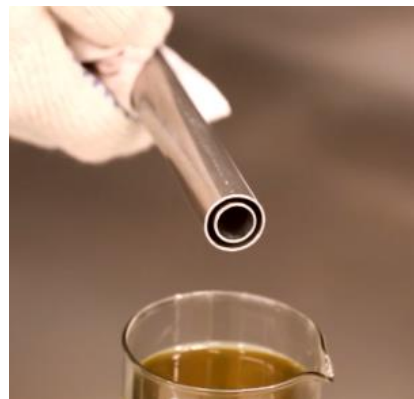
Dibujo 19 — El corte de la parte de medición de sensor y enjuagar el corte con combustible
