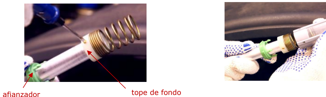
Dibujo 8 — Proceso de la instalación del filtro de malla de DUT-E
