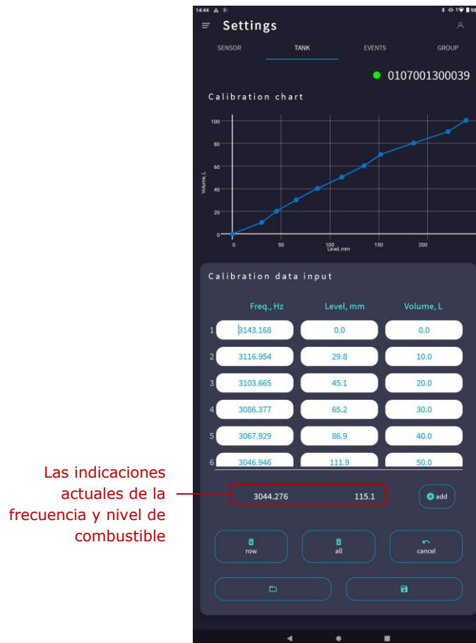
Dibujo 7 — Ejemplo de la creación de la tabla de calibración del tanque mediante la aplicación Monitor del Combustible en los Tanques
