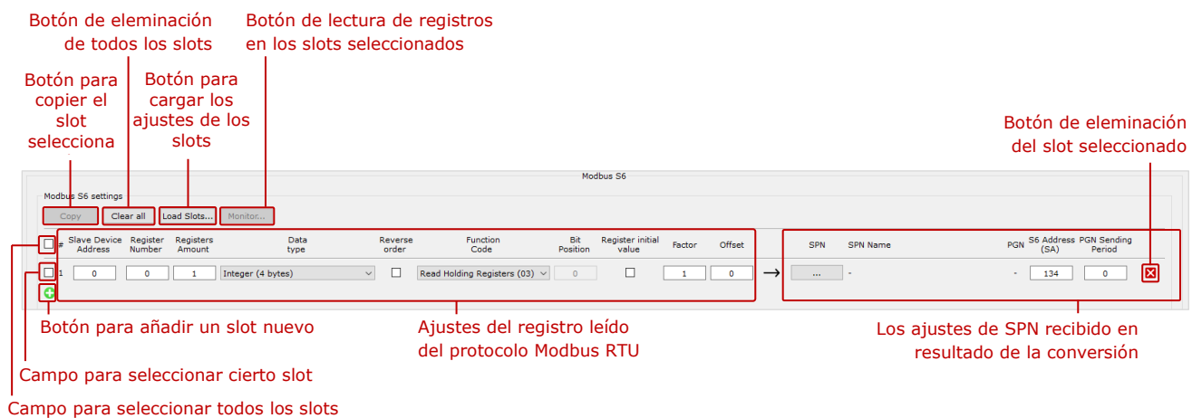
Dibujo 30 — Ejemplo del slot para la conversión de datos de los datos de los registros Modbus RTU en SPN submenú MF Modbus S6 en el software Service CANUp
