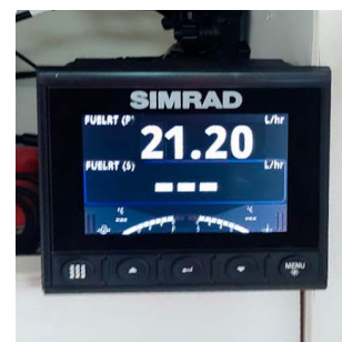
Consumo de combustible en la pantalla Simrad IS42J
