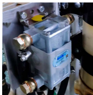
Flujómetro de combustible DFM 250D S7 instalado
