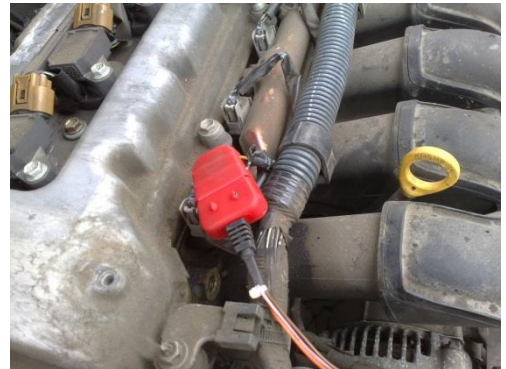
Dibujo 20 — Ejemplos de conectar Crocodile con cables de Vehículo
