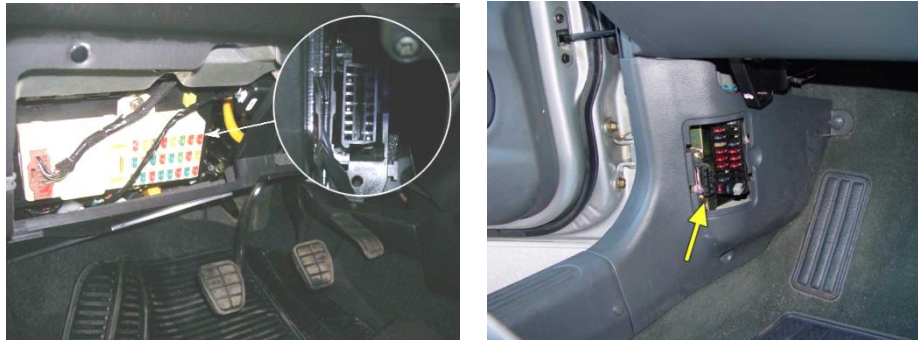
Dibujo 14 — Ejemplos de ranura OBD II en vehículo para diagnosticar
