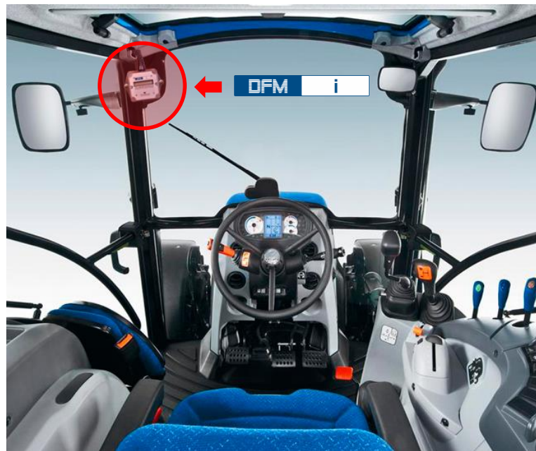
Dibujo 11 — Ejemplo del lugar de instalación de DFM i en la cabina del conductor de un tractor
