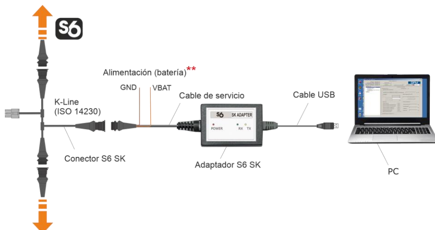
b) conexión del medidor DFM ACAN/CCAN/DCAN mediante S6 SK a través de la Tecnología S6
