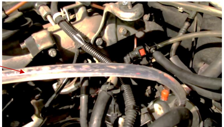
Dibujo 5 – Detección visual de la presencia de aire en combustible
