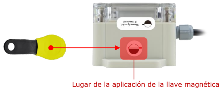
Dibujo 12— Conexión del modo de servicio del conversor GNOM S7 Radiobox CAN
