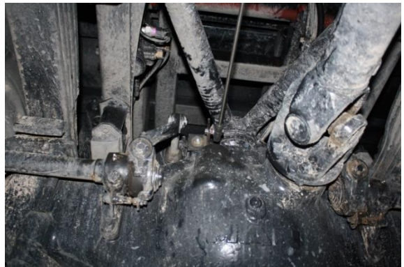
a) montaje del sensor al bastidor del Vehículo con los tornillos
