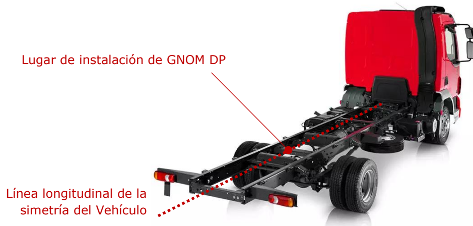
Dibujo 18 — Selección del lugar de instalación de GNOM DP para el control de la carga por eje del Vehículo
