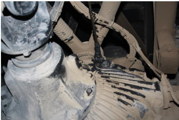
a) montaje del sensor al bastidor del Vehículo con los tornillos
