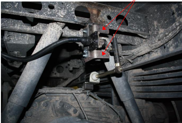
a) el elemento elástico está situado en el mismo plano con la palanca giratoria del sensor
