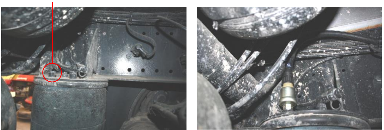
Dibujo 26 — Ejemplo del montaje del GNOM DDE en el cojín de la suspensión neumática del Vehículo
