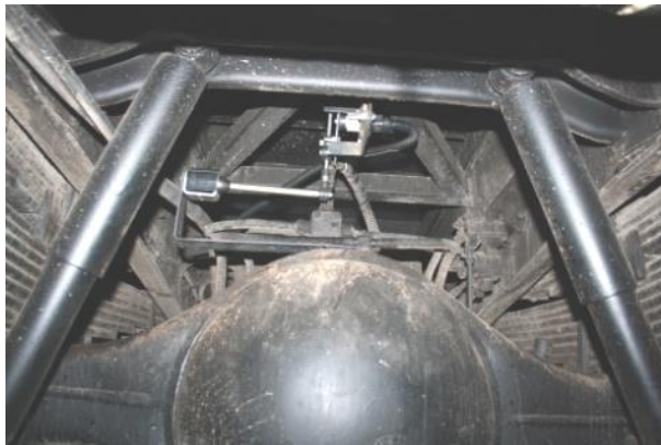
b) el elemento elástico está situado perpendicular a la palanca giratoria del sensor
