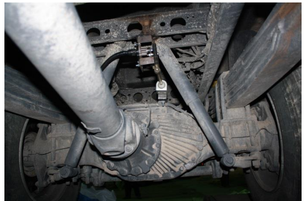
a) el elemento elástico está situado en el mismo plano con la palanca giratoria del sensor
