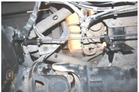
b) montaje del sensor al bastidor del Vehículo con la soldadura a puntos
