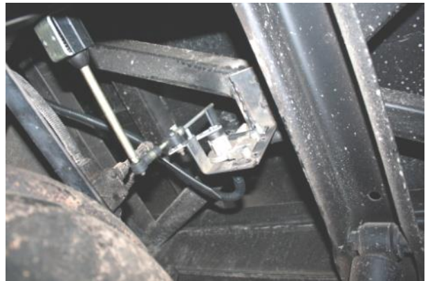
b) el elemento elástico está situado perpendicular a la palanca giratoria del sensor
