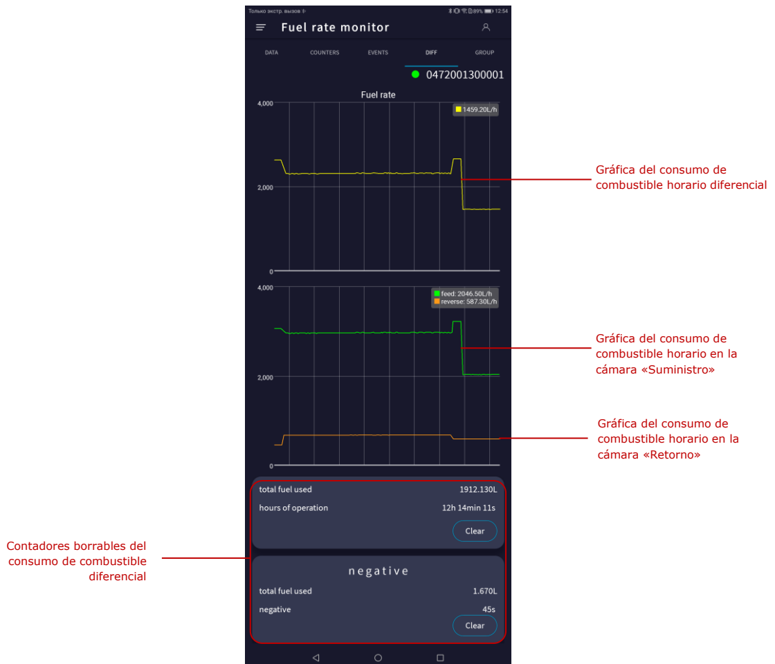
Dibujo 8 — Ejemplo de la visualización de las gráficas de los cambios del consumo horario y Contadores para la pareja diferencial de flujómetros funcionando en tiempo real
