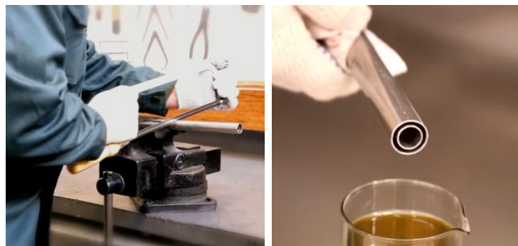
Figure 23 — Raccourcissement de la partie de mesure et rinçage de la coupe avec du carburant
