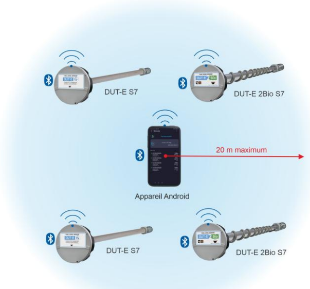
Figure 14 — Distance maximale admissible entre un smartphone/une tablette et les capteurs DUT-E S7 / DUT-E 2Bio S7
